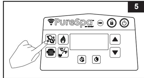
**IMPORTANTE:** Para evitar danos no motor do soprador de ar, nunca bloqueie a saída do soprador de ar durante o enchimento.
