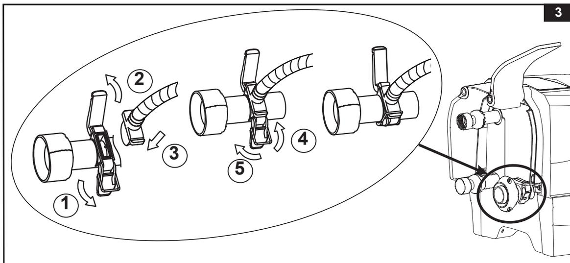
3. Desenrosque a tampa da válvula de ar no spa para aceder à haste voltada para cima para proceder ao enchimento. Inserir a outra extremidade da mangueira de insuflação (7) na válvula e rodar para a direita para a bloquear nessa posição (veja ilustração 4).
